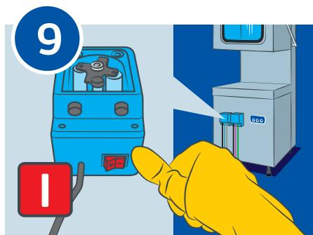
Включите дозаторы моющего и ополаскивающего средств.
