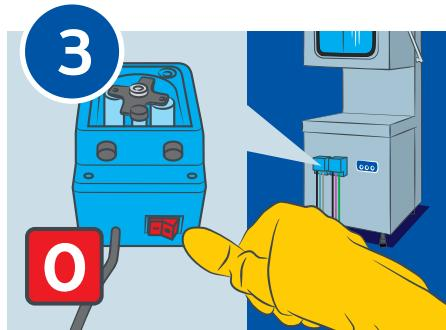
Отключите дозаторы моющего и ополаскивающего средств.
