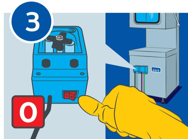
Отключите дозаторы моющего и ополаскивающего средств.
