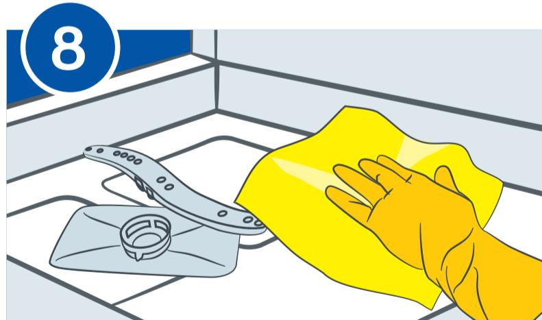
Отключите ПММ и слейте воду. Промойте чистой водой внутренние поверхности и части машины (решетку, перелив) и установите на свои места.
