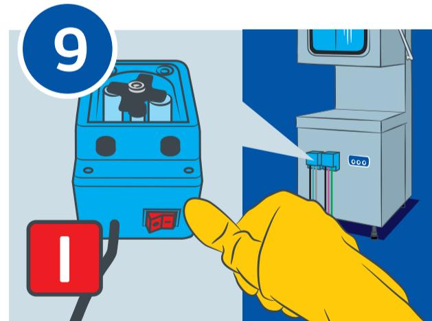
Включите дозаторы моющего и ополаскивающего средств.
