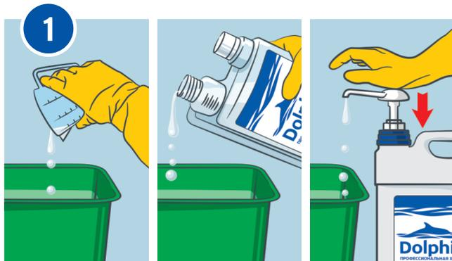
Приготовьте рабочий раствор моющего средства **TOPCLEAN (D 052)** удобным способом. Дозировка — 5 мл на 1 л воды. При использовании помпы сделайте 1 нажатие на 5 л воды.
