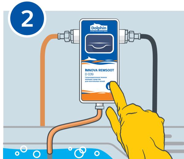
Приготовьте рабочий раствор моющего средства **REMSOOT (D 039)** с помощью автоматического дозирующего устройства.
