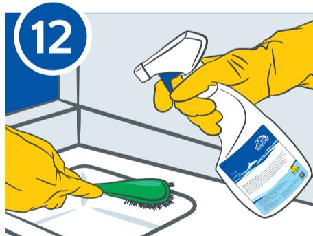
Промойте внутренние части машины. При наличии накипи используйте средство **ACID LF META (D 043)**, следуя инструкции по применению.
