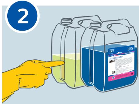
Проверьте наличие и правильность подключения к дозаторам моющего средства **REGULAR (D 028)** и ополаскивателя **DRY (D 034)** в канистрах.
