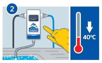
Приготовьте рабочий раствор моющего средства **PRIME** (D 048) с помощью дозатора. Концентрация: 20 мл средства на 1 л воды. Температура воды: не более +40°С.
