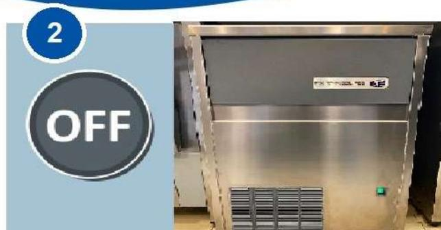
2 Отключите ледогенератор, выгрузите лёд в раковину, слейте воду и отсоедините съемные детали.
