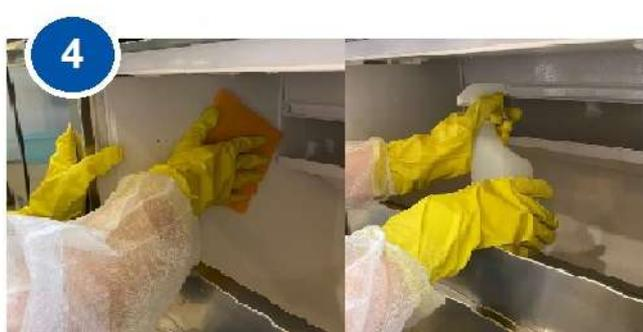
4 Нанесите протирочным материалом раствор средства **ACID LF META (D 043)** на поверхность мягкими движениями, сильно не втирая. Труднодоступные участки можете обработать из триггера.
